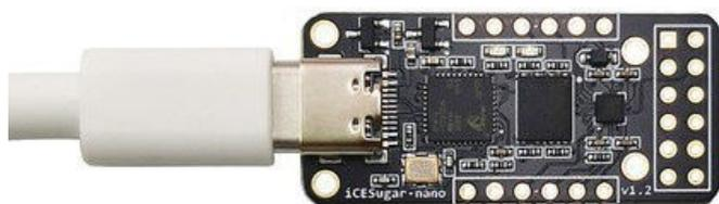
La particolarità di questa board è che è completamente open-source, e lo è anche il sistema di sviluppo, IceStorm, che permette di programmare tutta la famiglia iCE40. Non è potentissima ma permette di ospitare dei micro-softcore.
