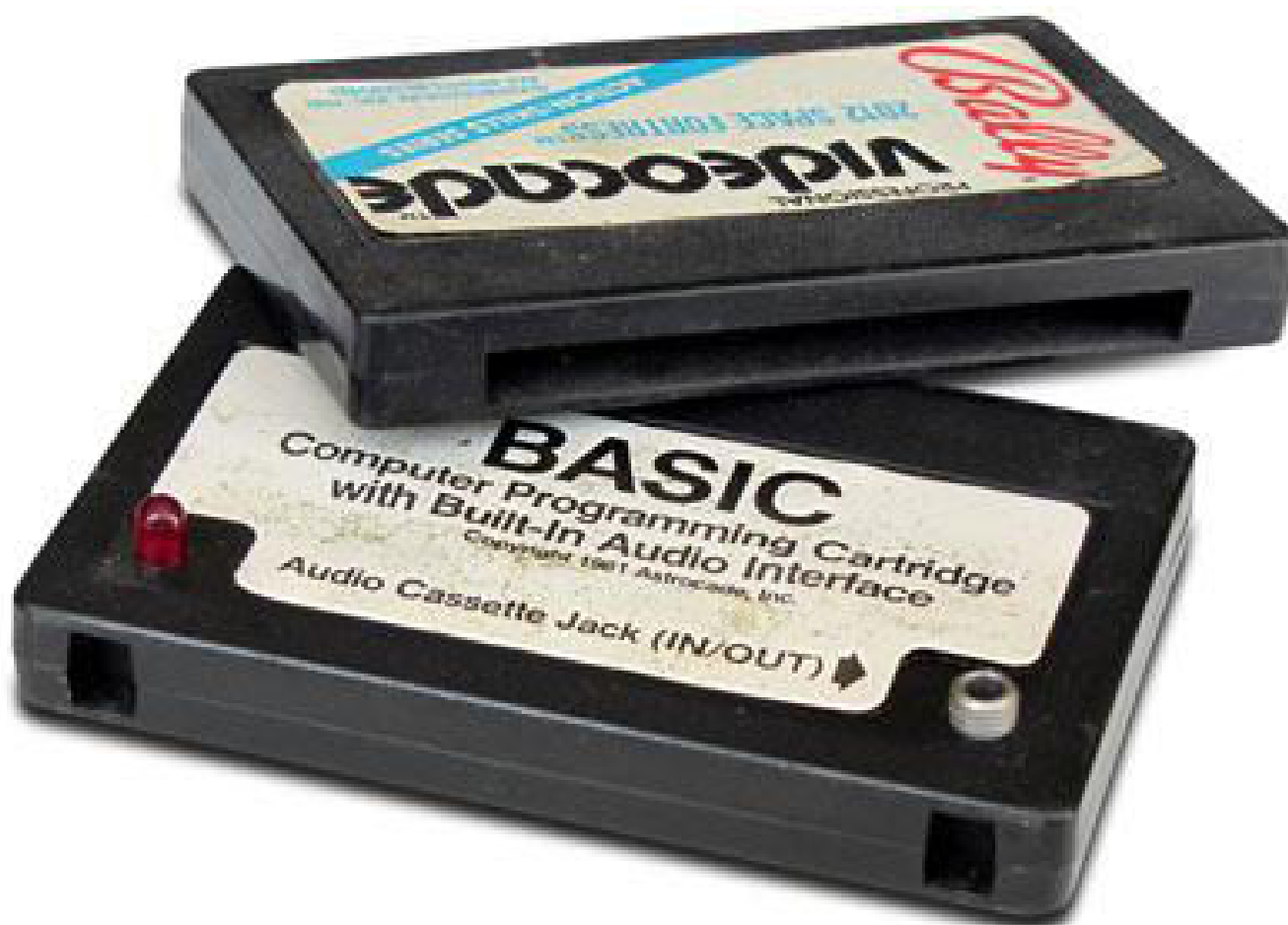
Fig. 8 - le cartucce della console, note anche come "videocades". Si noti la presa audio su quella del BASIC (fonte: oldcomputers.net)
