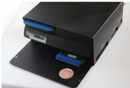
Lo ZX Spectrum aveva la stessa interfaccia con l'esterno dello ZX81 (cfr. "edge connector"). Il fatto che non fosse standard, non aveva impedito ad altre aziende di costruire circuiti esterni per ZX Spectrum come sintetizzatori vocali, stampanti, interfacce joystick, interfacce per floppy disc (cfr. OPUS Discovery in fig.15 e SANDY in fig.16).
