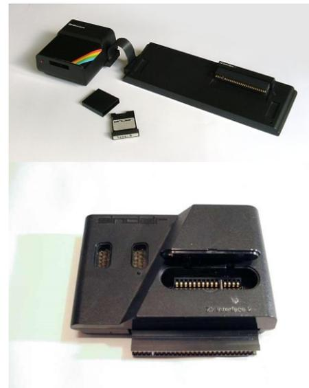
Oltre a una utilissima connessione RS-232, nella ZX Interface 1 si trovava anche una ROM "fantasma" di 8KB. L'accesso alla ROM "fantasma" avveniva disattivando la ROM principale in due casi: con l'esecuzione di una istruzione assembler "RST 8" oppure quando lo Z80 cercava di eseguire l'istruzione nella locazione 1708Hex della ROM principale.
