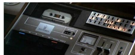
A causa della scomoda tastiera a membrana, per alleviare la difficoltà di digitare i programmi, i comandi in linguaggio Basic si inserivano premendo un singolo tasto. Per esempio, premendo il tasto G, appariva sullo schermo il comando GOTO.
